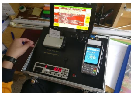
Kuva 3: Tyypillisen taksi-auton varusteet: taksamittari, kuittitulostin, tilausvälityspäätte ja maksupäätte. 32
